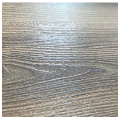
Fot. 4. Technika cyfrowego zdobienia z zastosowaniem tuszu hydroaktywnego umożliwia perfekcyjne odwzorowanie struktury drewna
