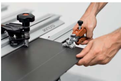
Fot. 8. Przełamywanie płyty za pomocą łamacza
