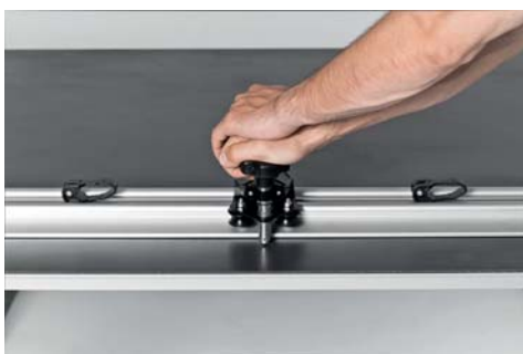
Fot. 7. Cięcie płyt za pomocą kółka wolframowego
