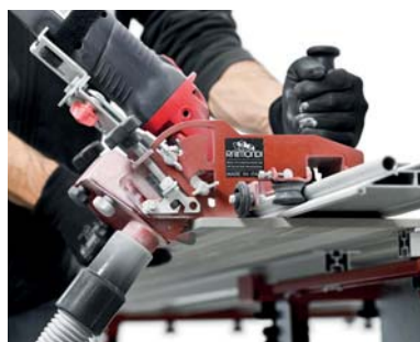
Fot. 11. Fazowanie płyt pod kątem 45° za pomocą urządzenia do cięcia mechanicznego
