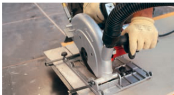
Fot. 4. Pilarka tarczowa do cięć prostych i ukośnych TC-180
