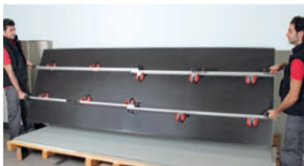
Fot. 2. Przenośnik do cienkich płyt wielkoformatowych (3–8 mm)
