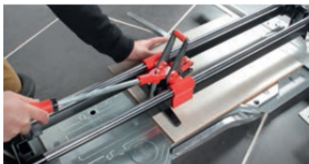
Fot. 3. Przecinarka ręczna TX-N do grubych płyt wielkoformatowych (6–20 mm)
