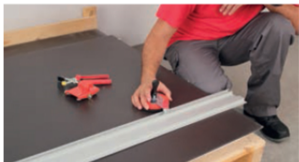
Fot. 1. Przecinarka SLIM CUTTER do cienkich płyt wielkoformatowych (3–8 mm)
