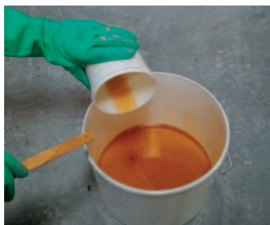
Fot. 1. Łączenie utwardzacza z żywicą reaktywną
