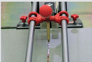
Fot. 4. W większości wypadków do cięcia wystarczy jednorazowe zarysowanie powierzchni wierzchniej strony płytki i siła nacisku łamania
