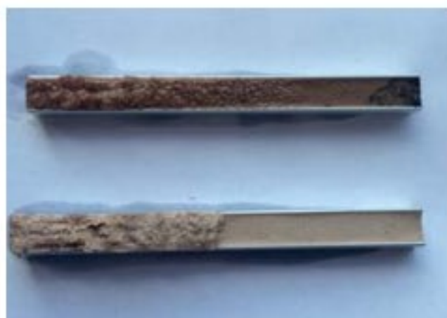
Fot. 2. Spoina epoksydowa ze wzornika z widocznym nabrzmieniem pod wpływem działania płynu EPOSOLV marki GEAL po 6 h
