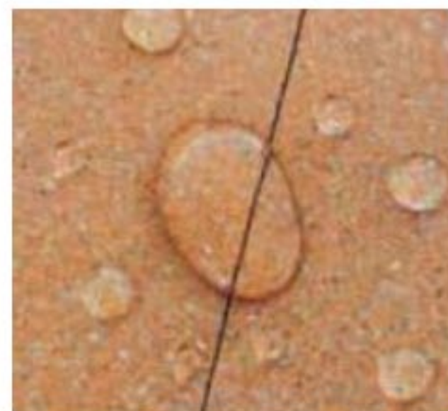
Fot. 3. Płytką klinkierową zaimpregnowana preparatem SCUDO marki GEAL; kropla wody, która nie wnika przez pęknięcie
